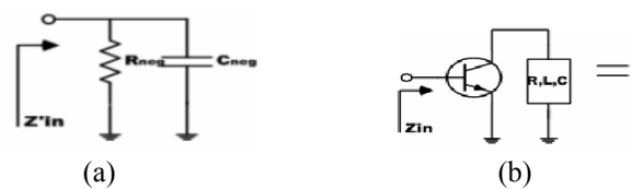
Gambar 1. (a) Rangkaian Resistansi Aktif, (b) Rangkaian Ekivalen
